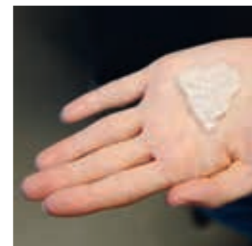
Гостю презентации предложено при помощи молотка испытать на прочность закаленное стекло душевой кабины Kermi. Результат приложенных физических усилий — мелкие нетравматичные осколки.
